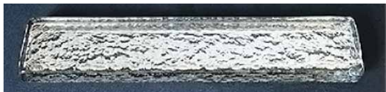
30. ガラスの型肌面に銀鏡加工した作例。CRT-c(廃ブラウン管リサイクルガラス)使用。
