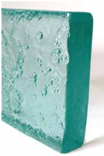
32. ガラスの片肌面に泡の様なテクスチャーをランダムに配置。FL (廃蛍光灯リサイクルガラス)、NX (廃ナトリウム灯リサイクルガラス)、クリアガラスを使用。150×100×T25mm / Φ170mm
