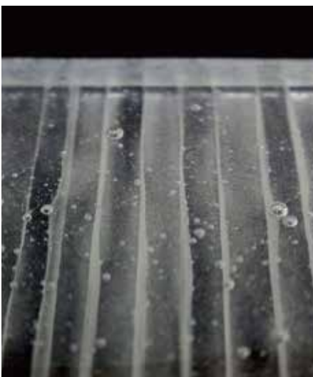
23. テクスチャーサンプル、ビルドを応用。CRT-c+t(廃ブラウン管リサイクルガラス)をデザインに合わせ構成。
