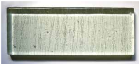
32. ガラスの片肌面に泡の様なテクスチャーをランダムに配置。FL (廃蛍光灯リサイクルガラス)、NX (廃ナトリウム灯リサイクルガラス)、クリアガラスを使用。150×100×T25mm / Φ170mm
