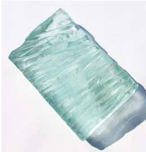
20. 流水をイメージ。サンプルテクスチャー、プラスターよりも表面の凹凸を多めに作成。 NX (廃ナトリウム灯リサイクルガラス)、CRT-c (廃ブラウン管リサイクルガラス) 使用。
