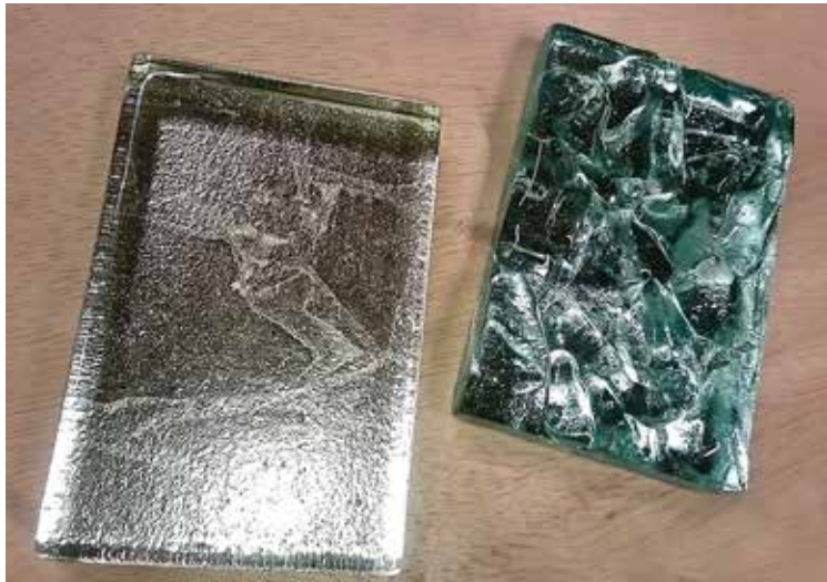
16. ガラスの背面に銀引き加工。
