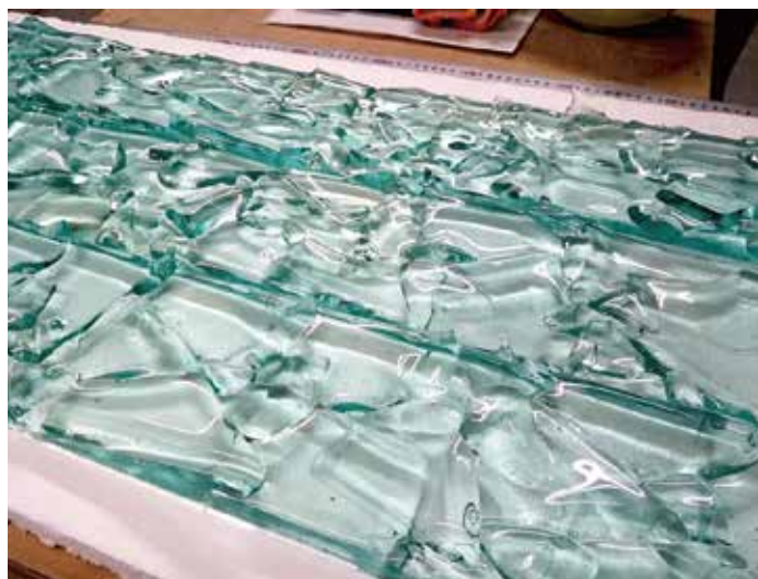
14. テクスチャーサンプル、バンピーをベースに凹凸を強めに制作。NX(廃ナトリウム灯リサイクルガラス)使用。
