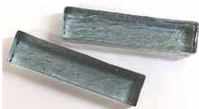
18. CRT-c(廃ブラウン管リサイクルガラス)を使用したブロック。210×50×T40mm≒約1.2kg
