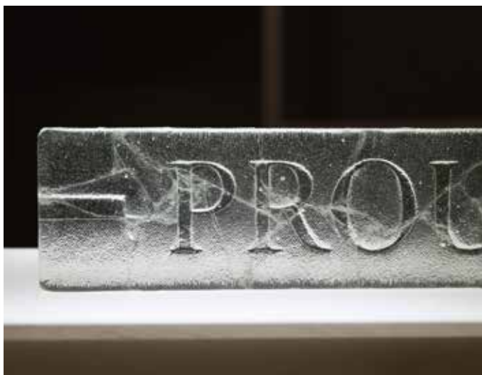
6. テクスチャーサンプル、ビルドをベースにレリーフ状に焼成。FL (廃蛍光灯リサイクルガラス) 使用。
