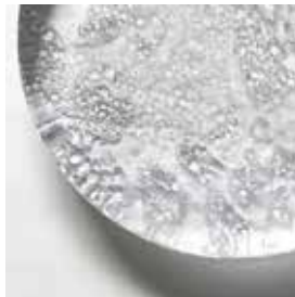
32. ガラスの片肌面に泡の様なテクスチャーをランダムに配置。FL (廃蛍光灯リサイクルガラス)、NX (廃ナトリウム灯リサイクルガラス)、クリアガラスを使用。150×100×T25mm / Φ170mm
