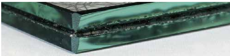
32. クリア板ガラスを波状に焼成し、高透過ガラスに合わせた作例。100×300mm
