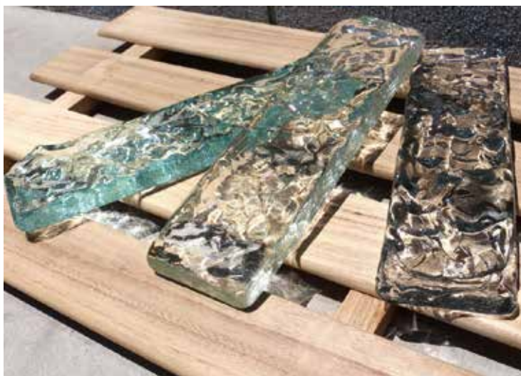
27. ホットキャスト制法にて制作。ガラスの表面にランダムに模様をつけ、光の反射を見せる作例。
